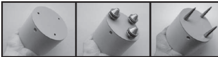
Figura B. 1 - Versione "GEMINI HVSr" basilare impiegata per la prospezione sismica passiva: dettaglio dei supporti intercambiabili in dotazione, da sostituire a seconda che si acquisisca su superficie rigida o su terreno.
