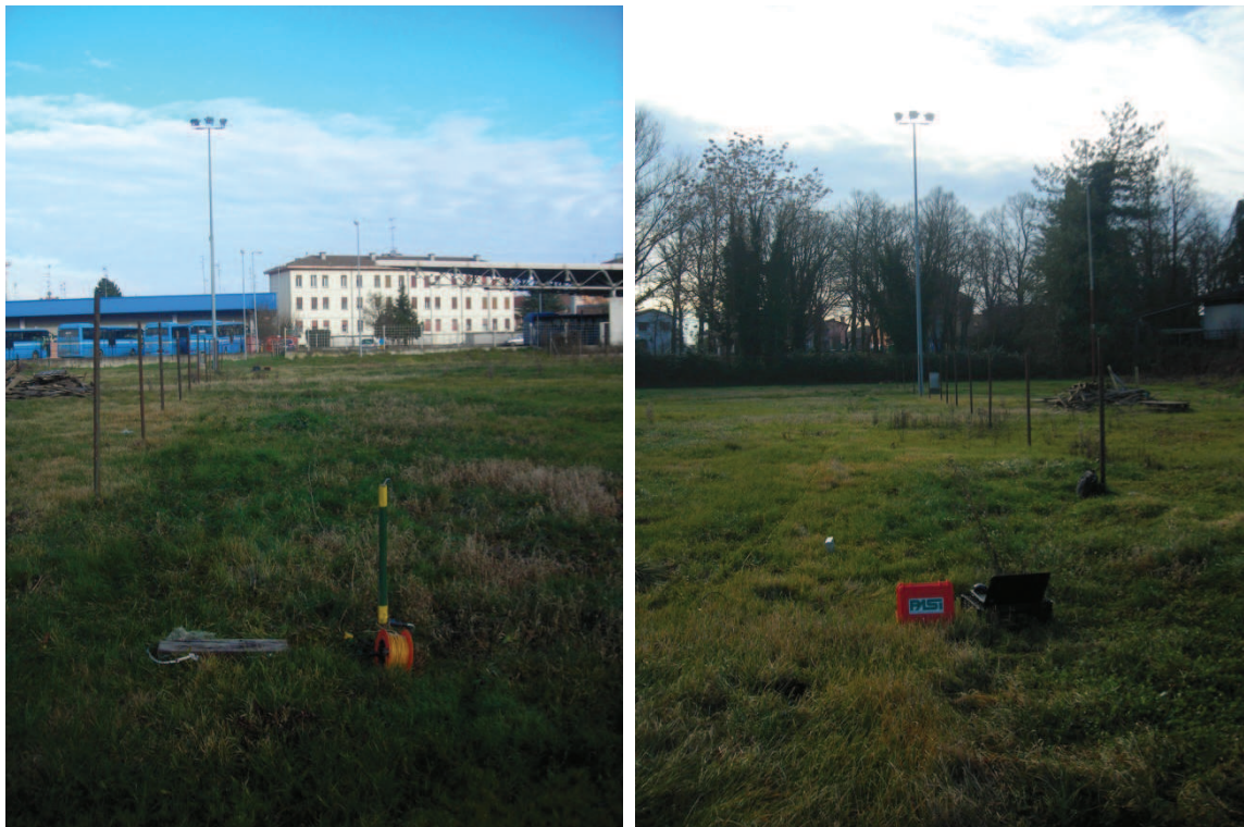
Figura B. 3 - Stendimento sismico MASW realizzato in corrispondenza dell'area di studio.
