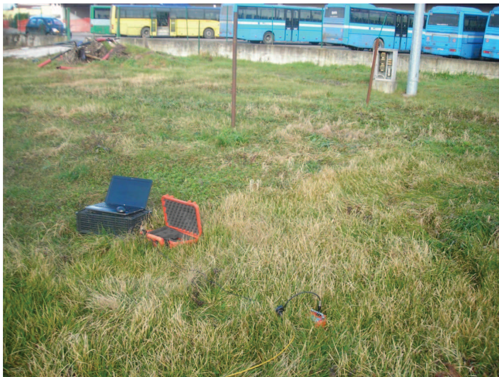
Figura B. 4 - Acquisizione HVSR1 realizzata in corrispondenza dell'area di studio.
