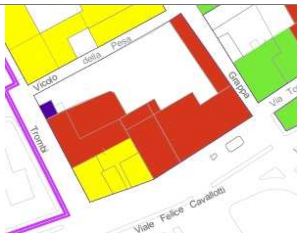
Esito valutazione del danno - Scheda AeDES = crollato/demolito
